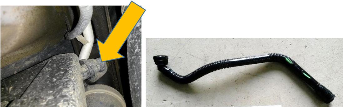
7. Sensor am Ansaugrohr abnehmen und um 180° gedreht wieder einbauen
