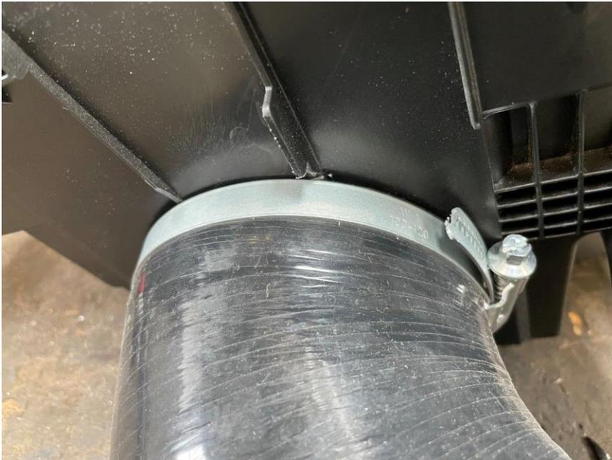
13. Die weiteren Schlauchbögen und Aluminiumrohre von unten nach oben wie folgt im Motorraum zusammenbauen:
