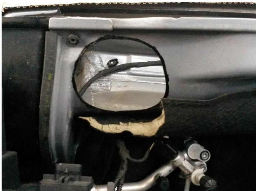
9. Ansaugrohr zum Luftfilterkasten (Teile Nr. 7E0 129 578 B) ausbauen. Das Rohr wird nicht mehr benötigt.
