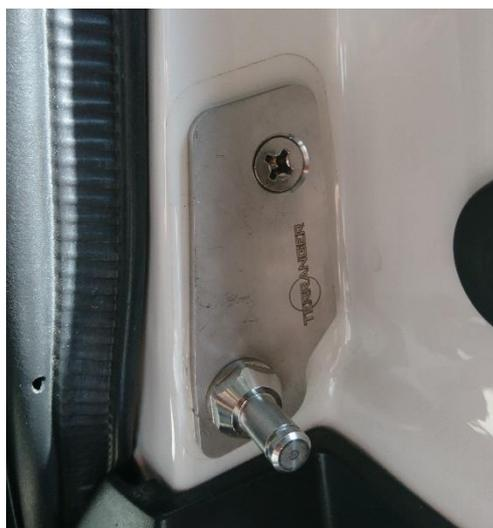
neue verstärkte Gasfederaufnahme (unten)
