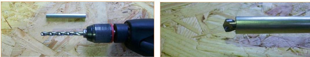
12. Drei Bohrungen je Seite einbringen. Bohrungen entgraten und gegen Korrosion schützen (Rostschutzgrundierung, Fahrzeuglack und Hohlraumwachs). Haltekonsole (Teil 1) nochmals positionieren, Außenkontur kennzeichnen, Haltekonsole abnehmen, gekennzeichnete Fläche mit 3M-Klebeband (Teil 6) abkleben.
