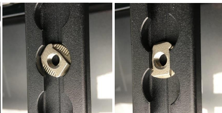
Mutter in Position schieben
