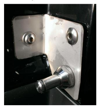
5. Gewindebolzen (Teil 8) einschrauben. Steckschlüssel-Einsatz 6-kant 18 mm,  $M_d$  = 30 Nm. Bolzen einfetten.
