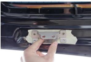
7. Haltekonsole (Teil 1) positionieren. Das Maß 74 mm von der <u>Außenkante</u> des Kugelkopfes der originalen Gasfederaufnahme bis zur Mitte der Haltekonsole (kleine Kerbe, siehe Bild unten) muss auf 1 mm genau eingehalten werden.
