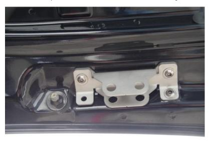
12. Steckbolzen (Teil 2) einfetten. Die neuen Gasdruckfedern mit der Kolbenstange nach unten einbauen. Dazu erst den oberen Gelenkkopf an der mittleren Bohrung der Haltekonsole positionieren, die Scheibe (Teil 3) an der Innenseite zwischen Haltekonsole und Gelenkkopf schieben und nun den Steckbolzen (Teil 2) durchstecken. Den Federstecker (Teil 4) an der Außenseite durch die Bohrung des Steckbolzens stecken.
