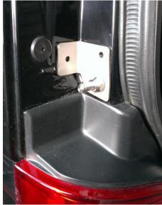
b) Darauf achten, dass die Schenkel des Winkels flächig am Blech der Karosserie anliegen. Sollte dies nicht der Fall sein, ist der Öffnungswinkel anzupassen. (Winkel vergrößern oder verkleinern).
