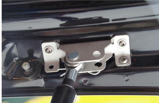
„oberer Anlenkpunkt“, an den Rahmen der Heckklappe genietet
