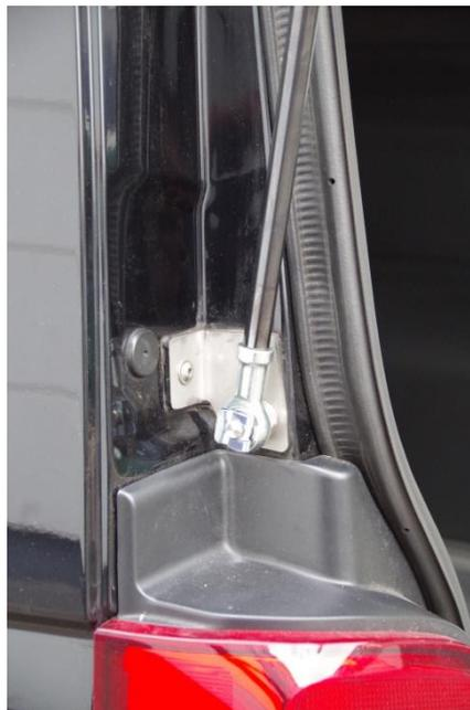
„unterer Anlenkpunkt“, hier mit dem optional erhältlichen Versteifungswinkeln (ab Gasfederkraft 1300 N erforderlich)
