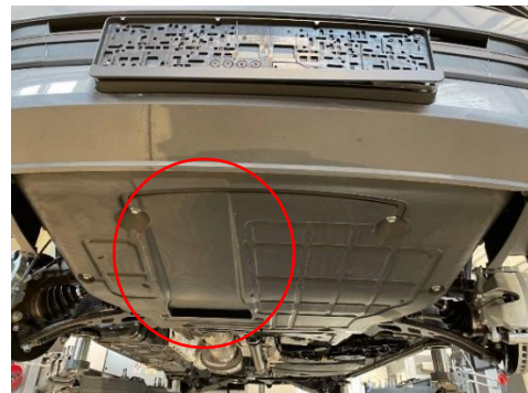
Abb. Kunststoffabdeckungen mit Luftkanal im eingebauten Zustand
