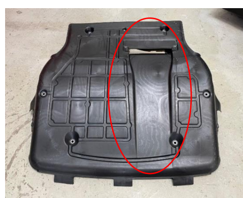
Abb. Kunststoffabdeckungen mit Luftkanal im ausgebauten Zustand
