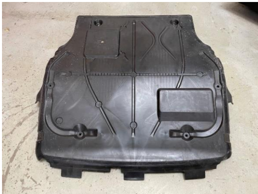
Abb. Kunststoffabdeckungen ohne Luftkanal im ausgebauten Zustand
