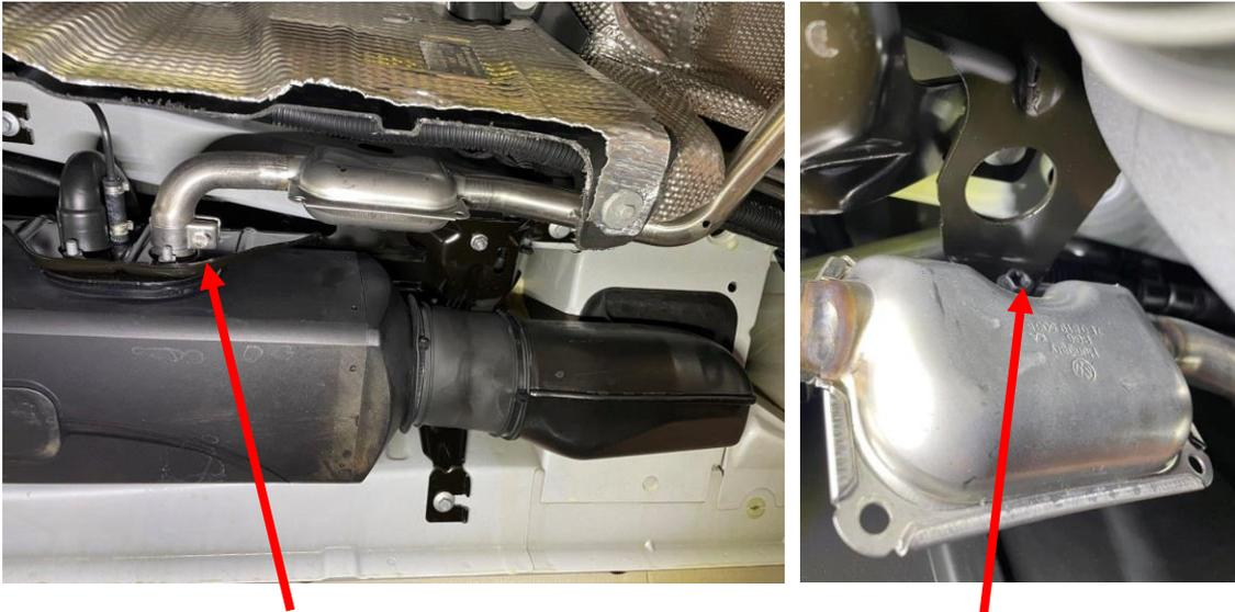
Dazu die Klemmschelle lösen und den Schalldämpfer an seiner Aufhängung abschrauben.
