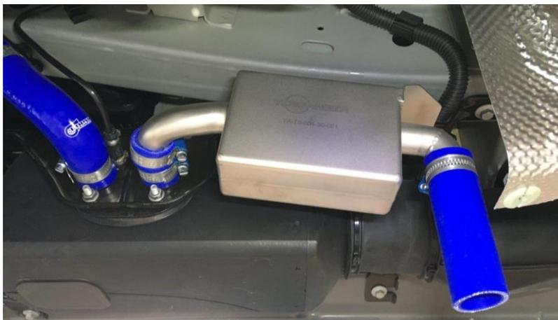
Das Schlauchstück (Teil 2) dient dem Anschluss des Schalldämpfers an den Abgasstutzen der Standheizung. Die Schelle (Teil 3) wie abgebildet positionieren:
