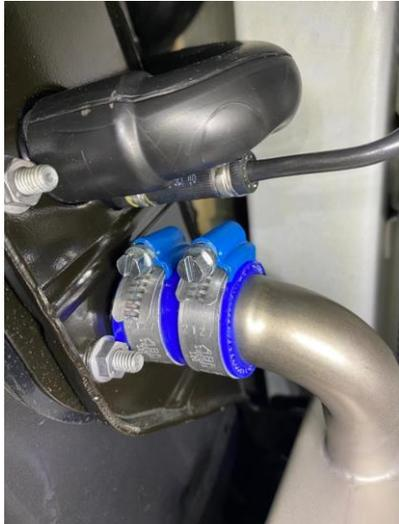
Den Schalldämpfer mit der Mutter M6 befestigen.
