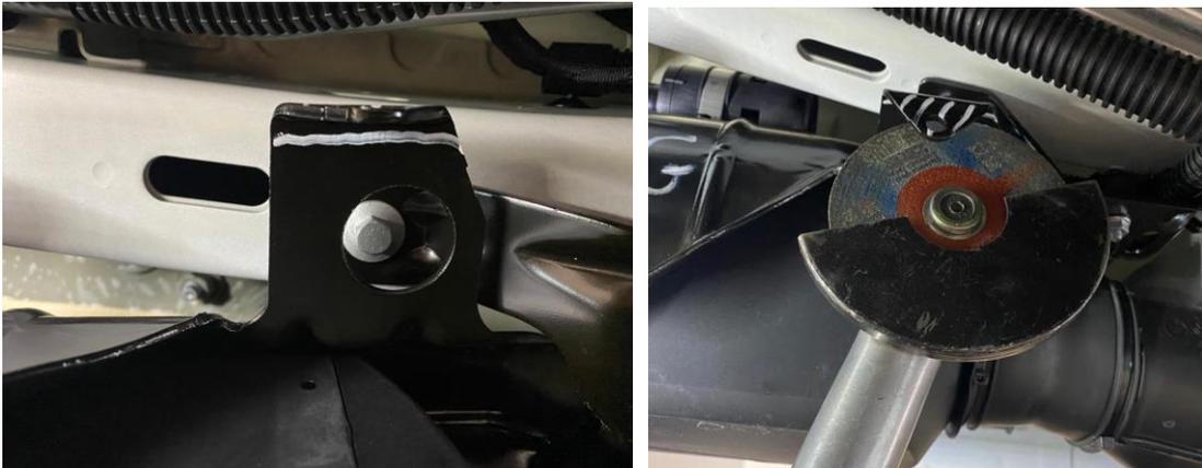
Das linke Bild zeigt den abgetrennten Teil der Halterung. Dieser Abschnitt wird nicht mehr benötigt. Schnittkante entgraten und fachgerecht gegen Korrosion versiegeln.
