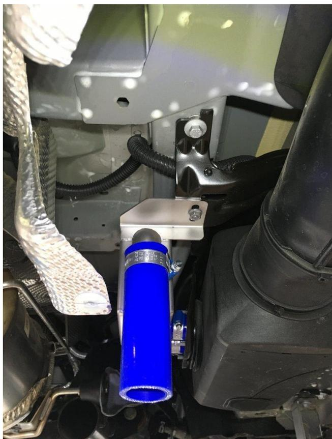
Wasserdichter Schalldämpfer Luftstandheizung
